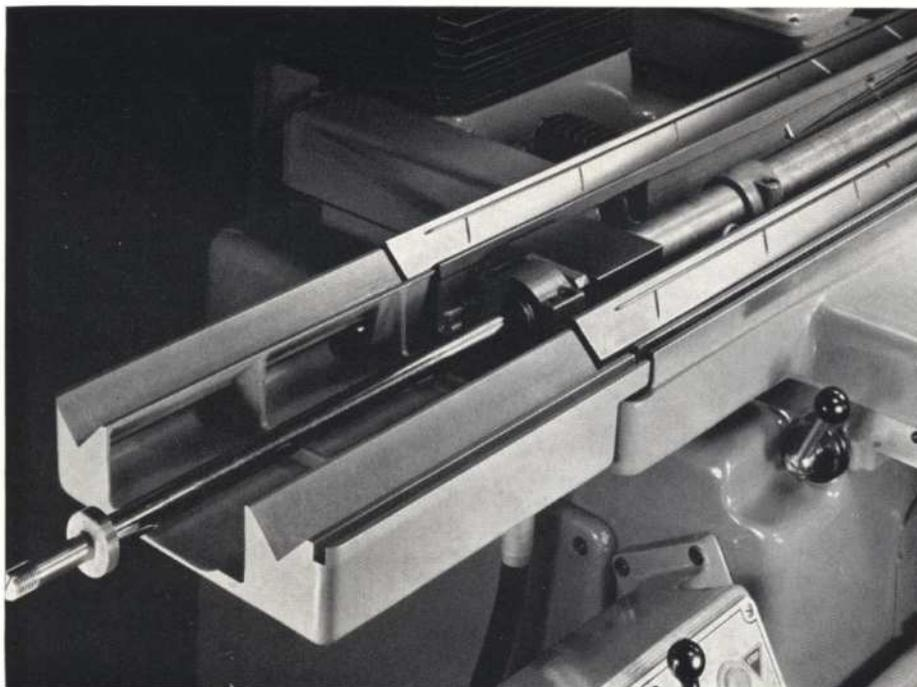
Bild 12 zeigt den Staubschutz für die Unterseite des Schleiftisches des Maschinentype JUNG F 50. Dieser Staubschutz verhindert, daß Schleif- oder Abdrehstaub durch die Bewegungen des Schleiftisches oder äußere Einflüsse, wie Luftumlauf, an die Unterseite der Führungsbahnen gelangen kann. Der Schleiftisch läuft dabei auf beiden Seiten in die prismenartigen Gleitschutzbahnen, welche ganz dicht angesetzt sind und Abdreh- und Schleifstaub nicht durchlassen.
