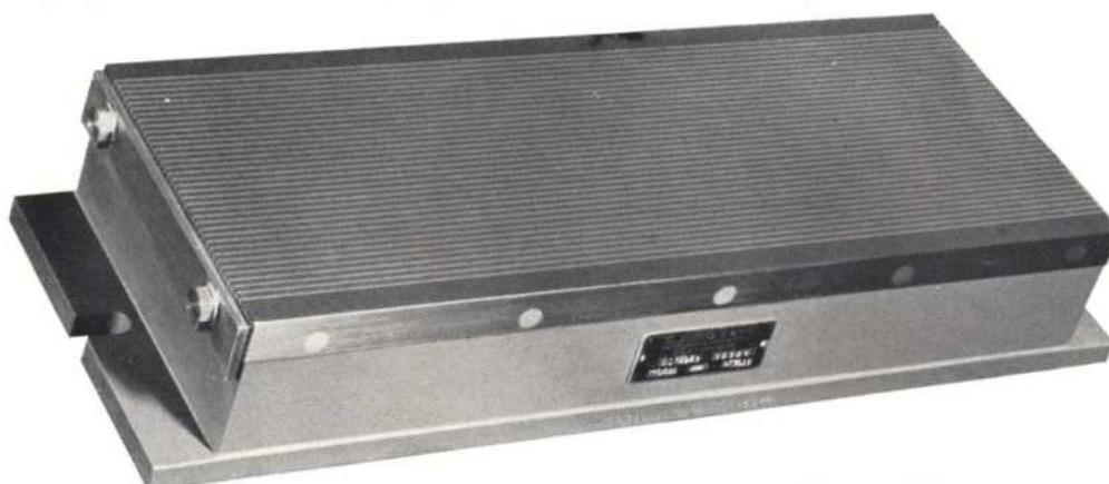
Bild 25: Elektro-magnetische Spannplatte mit enger Längspolteilung
